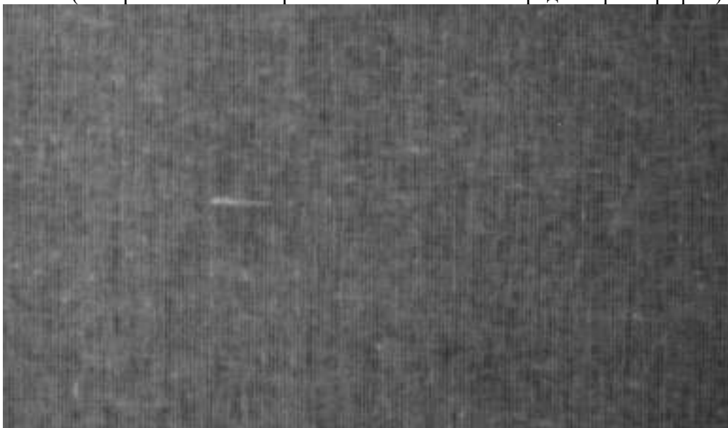
Рисунок 1 – Фотоснимок дефекта текстильного материала «слёт»
